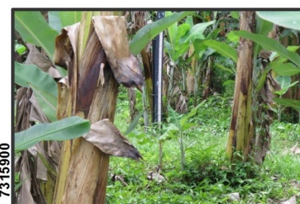
Régua linimétrica próximas às margens do rio. Notar que as inundações no local ocorrem com grande variação no nível d'água (mais de 7 metros).
